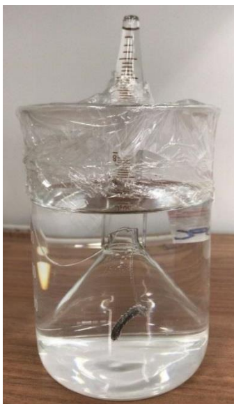
Figura 4. 3: Montagem utilizada para a medida da taxa de corrosão por meio da quantidade de hidrogênio gerada.
