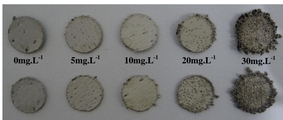
Figura 5.18: Efeito da concentração de SLS no aspecto visual dos depósitos de níquel produzidos utilizando catodo de (a) aço inoxidável 316L e (b) titânio grau 2.
